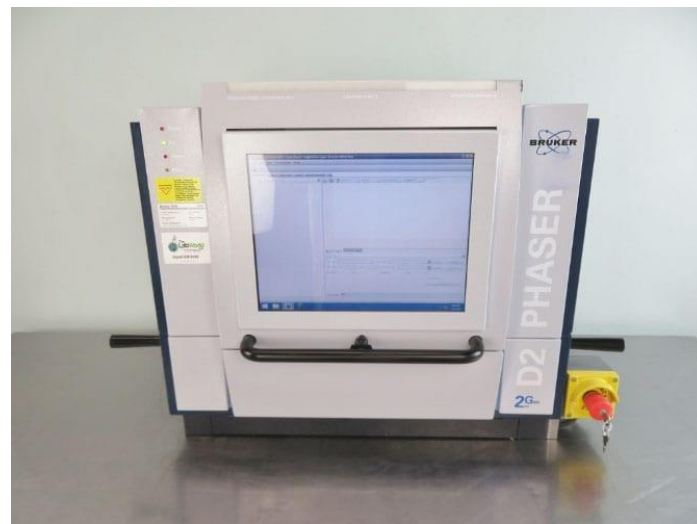
Benchtop XRD (Bruker D2 PHASER)
